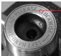
Auf dem linken Achszapfen ist eine Gravur, die das Linksgewinde anzeigt.
